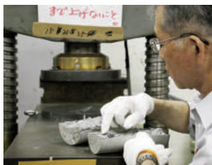
割裂したコンクリートの状況
